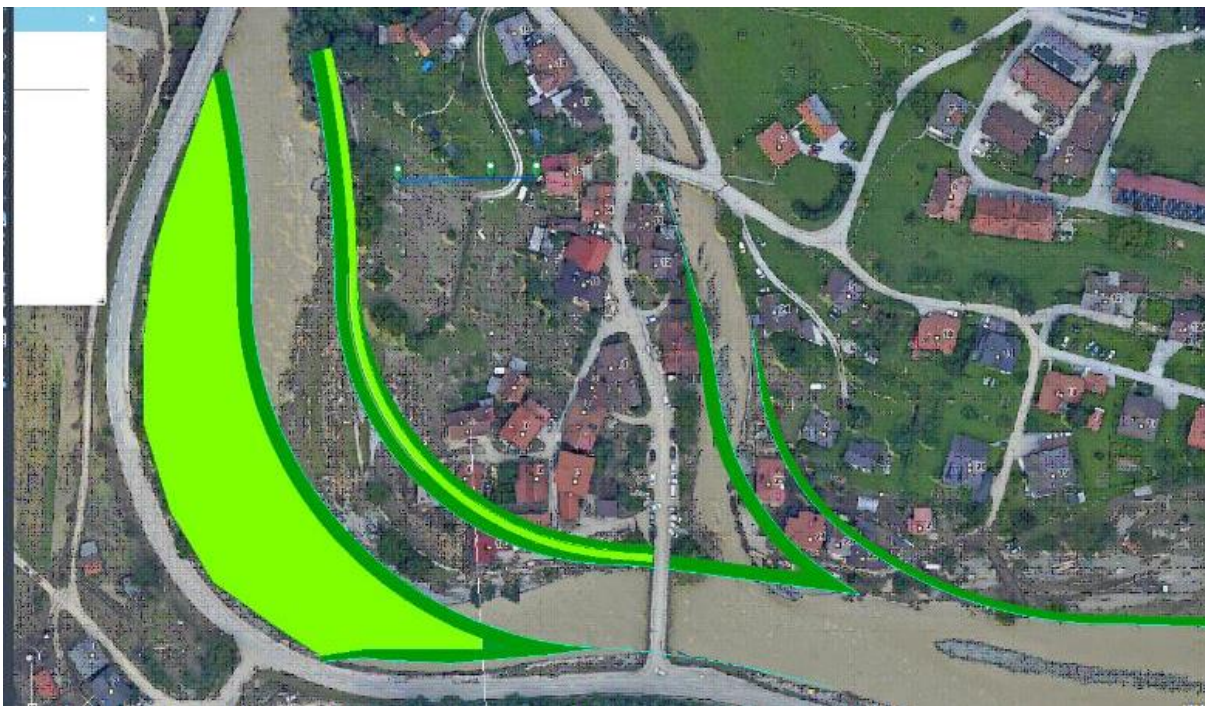
Slika 3: Možnost ureditve Savinje in izboljšanja hidrodinamičnih razmer na širšem območju sotočja z Ljubnico
